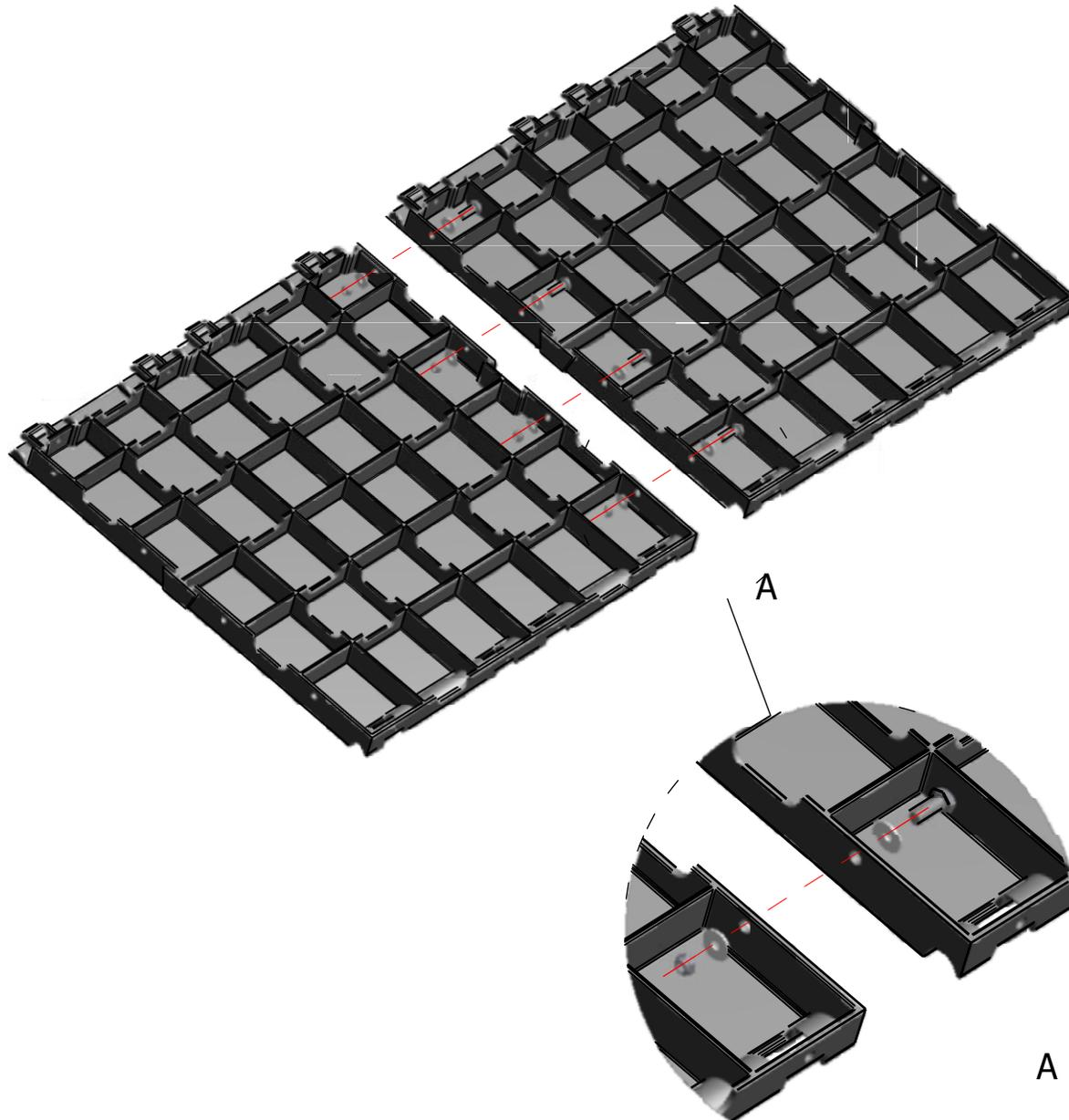
Beispiel einer Verlegung in einem 6 x 9 m Zelt. Der Boden wird in der Verknüpfung versetzt verlegt (dunkelgrau) und mit Einzelplatten am Rand ergänzt (hellgrau) oder mit Zweierplatten
